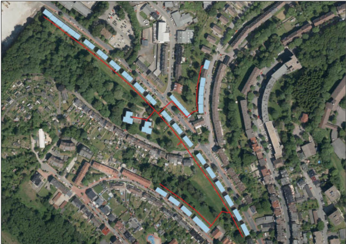
Abbildung 3-10: Wärmeverbund Gebäude der LüWo an der Brüderstraße
